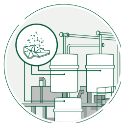
10 重合 高温・真空状態の中で、 樹脂の内部に染み込んだ 不純物を吸い出します。
